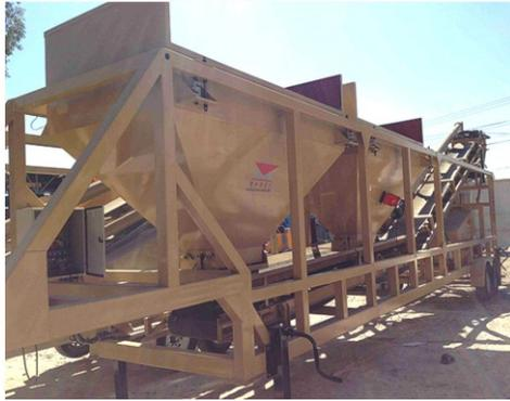
2 Tolvas basculante de agregados con capacidad de 5m<sup>3</sup>, estructura y tolva en acero A-36.
