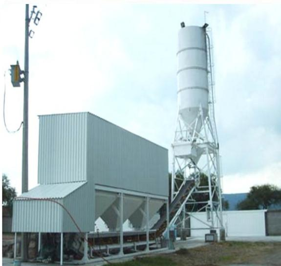
Este sistema consta de 20mts. De estructura de acero armado para transportar agregados.
