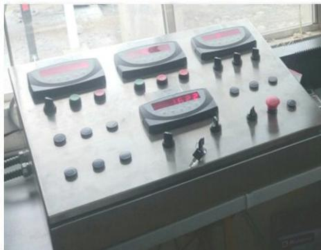
Este tablero puede colocarse a una distancia de 10 m de la planta, dentro de una caseta de mando (si el cliente lo desea).
