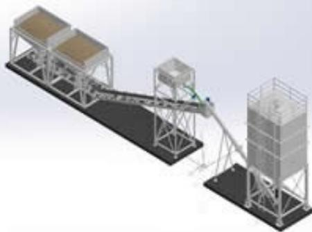
Tolva basculante de agregados con capacidad de 7m<sup>3</sup>, estructura y tolva en acero A-36.
