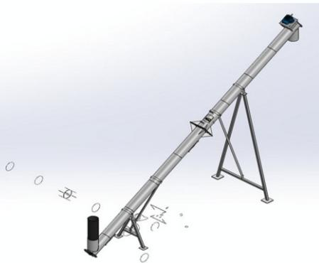
Tipo bazuca helicoidal con motor reductor de 5 H.P. con diámetro de 10", equipado con compuertas para limpieza, chumaceras selladas y doble chumacera interior de soporte en acero blanco, con manga cubre polvo.
